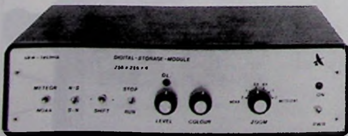
Afb. 9 Digitaal beeldgeheugen, model YU3UMV, met 256 x 256 x 6 bits. Fabrikaat UKW-Technik.
